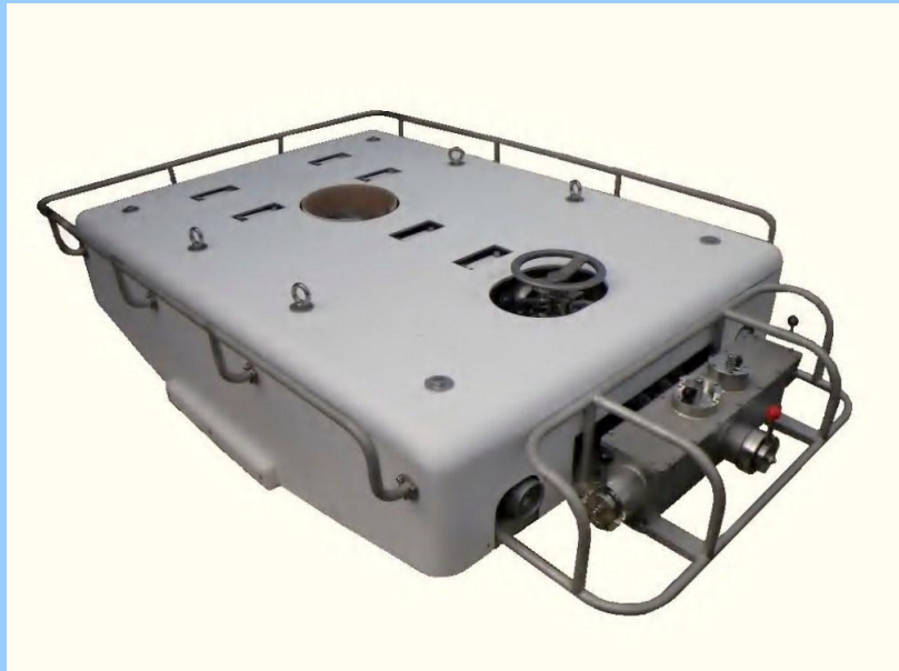
図-3 水中船体清掃機（SEA DRAGON）電動式・回収装置付
